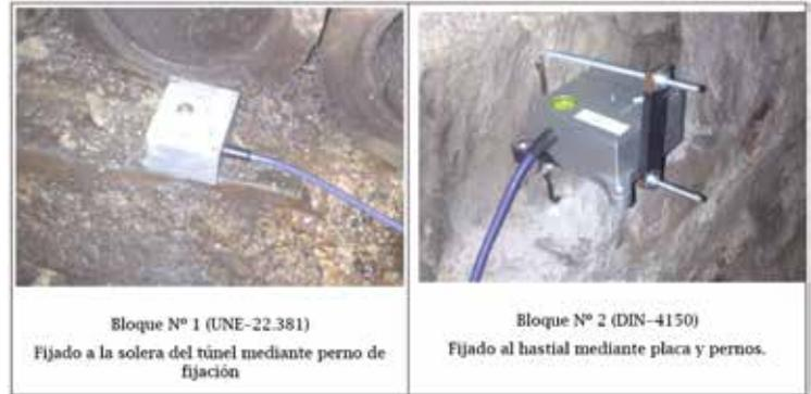
Figura: Disposición de bloques de medida del SISMOGRAFO S-2 (Nº serie 0351). PK-407+400.
