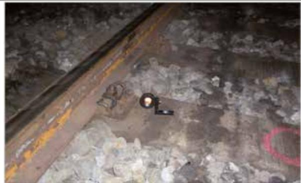
Fotografía: Prisma de nivelación en solera de túnel en servicio.
